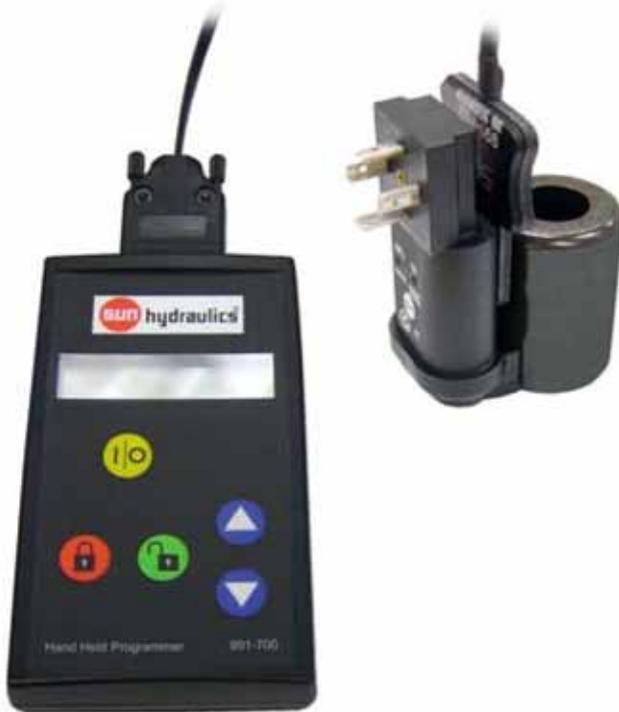
1. Stecken Sie den Infrarotadapter auf den Verstärker und achten Sie auf die Orientierung – die Seite mit dem Logo zeigt in Richtung Verstärker. Der 9-polige Stecker verbindet das Adapterkabel mit der seriellen Schnittstelle des Handprogrammiergerätes (HHP) oder des PCs.
