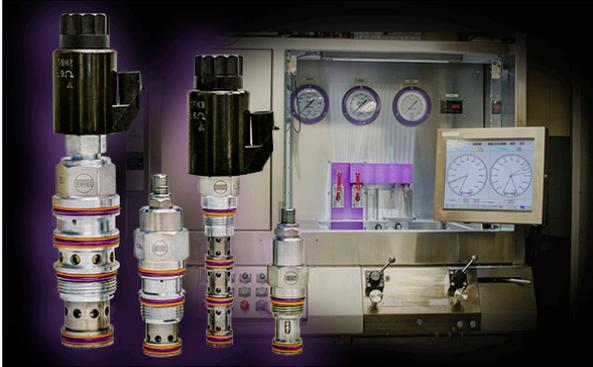
Les joints EPDM, ou Éthylène Propylène Diène Monomère, sont compatibles avec les fluides de type 4 et 5 des marques déposées telles que Skydrol®, Fyrquel®, HyJet™ et Pyrogard™ 53, et offrent une grande stabilité pour de larges variations de température. Les cartouches équipées de joints EPDM sont le bon choix pour des catégories d'applications sévères .
